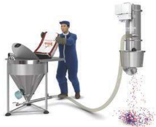
Materialaufnahme mit Ladestation mit Füllstandssensor
