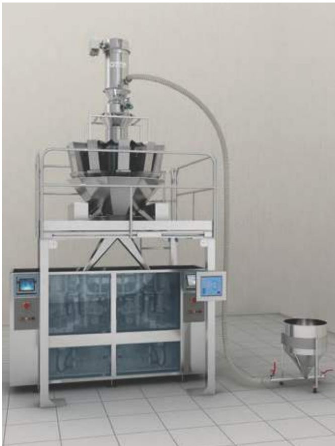
Befüllung einer Dosiereinheit für eine Doppel-Abfüllanlage
